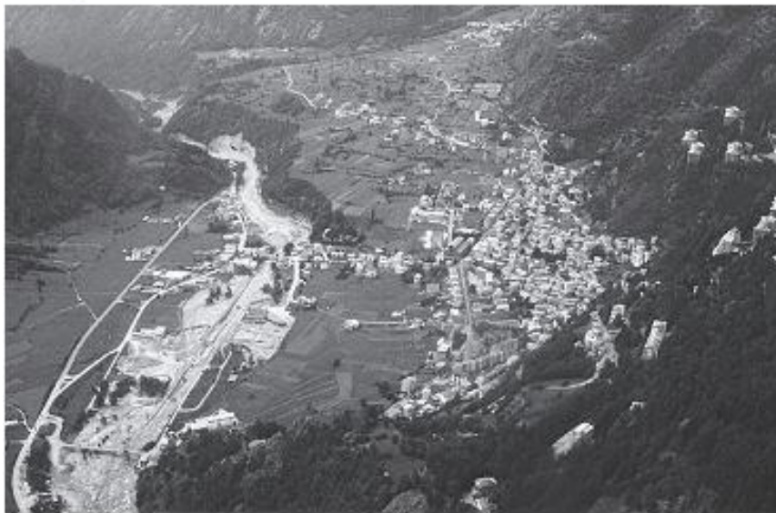
Figura 11 - Esondazione dell'Adda in località Bolladore (comune di Sondalo). Si notino le erosioni spondali causate dal Fiume durante l'alluvione del luglio 1987 (foto Dott. Roberto Potenza).
