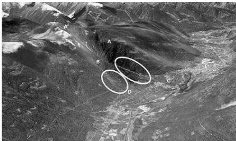
Figura 5: Immagine aerea del conoide di Sernio. A) Costa dei Lia e Castamoscia; A') Area della Frana di Corno Rosso; B) area di distacco della Frana del Fosso dello Stradello; C) conoide di Sernio; D) conoide del Fosso dello Stradello; E) Tirano. All'interno delle ellissi, ancora una volta, si apprezza la posizione della porzione apicale dei due conoidi.
